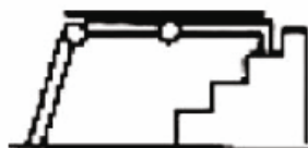
SCHODIŠŤOVÉ LEŠENÍ SCHODIŠŤOVÉ LEŠENIE
